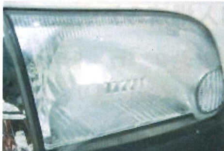
内部リフレクタの劣化
